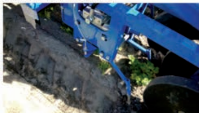
Dettaglio zappette inter-pianta | Inter-plants hoes detail Détail des houes entre-plants | Деталь - прополка между растениями Hacken unten den Reihen Detail | Detalle de las azadas entre plantas
